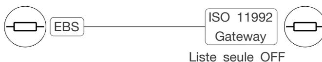
Pour garantir un fonctionnement correct, le commutateur à glissière doit être réglé sur « Listen Only OFF » (écoute seule).
