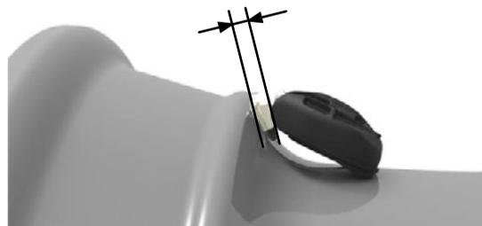
⑤ Premere e tenere il sensore contro il cerchio come mostrato nell'immagine precedente. Serrare la vite T30 con un cacciavite dinamometrico calibrato a 6,0 Nm  $\pm$ 0,5 Nm.
