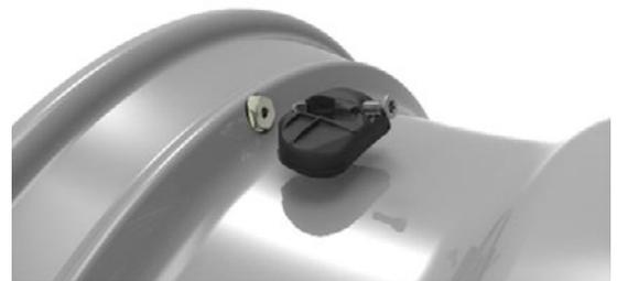
③ Coloque el sensor en la parte interior de la llanta en la cabeza de la válvula y fíjelo con el tornillo de forma que el sensor pueda moverse con facilidad.
