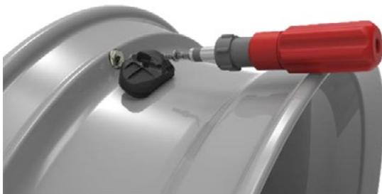
④ Presione el sensor contra la llanta y sujételo de modo que descansa sobre la base de la llanta. La cabeza de la válvula debe sobresalir de cualquier avellanado para que haya un espacio entre la parte delantera del sensor y la llanta.
