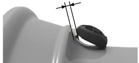
⑤ Presione y sujete el sensor contra la llanta como se muestra en la imagen anterior. Apriete el tornillo T30 con un destornillador dinamométrico calibrado a 6,0 Nm  $\pm$ 0,5 Nm.
