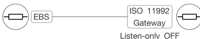
Um die korrekte Funktion sicherzustellen, muss der Schiebeschalter auf Listen Only OFF gestellt sein.
