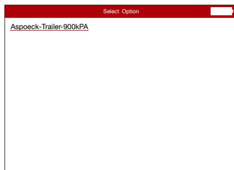
④ Mit dem Aspöck TPMS Diagnostic Tool T350 jeden Sensor mit *Enter* anlernen. Mit den Pfeiltasten ist die Auswahl der Reifen möglich.
