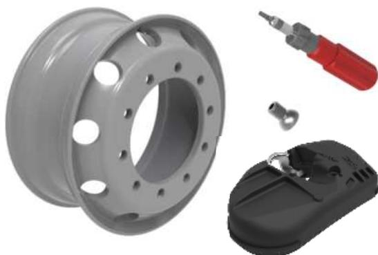
② Montare la valvola del pneumatico secondo le istruzioni del produttore del cerchio, assicurandosi che la valvola sia allineata correttamente. La valvola deve essere dotata di una superficie di accoppiamento adeguata sulla testa della valvola e di un foro con filettatura M6x1 mm.
