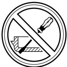
Eine zerstörungsfreie Demontage von bereits montierten FlexLED Bändern ist nicht vorgesehen.
