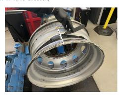
B Die Halterung in Position halten. Die Abschnitte fest zusammendrücken, dass der gesamte Klettverschluss vollständig in Kontakt ist. Den Gurt mit 180N anziehen. Holding the cradle in position, fasten the strap so that all of the hook and loop sections are fully in contact and press the sections together firmly. Tighten the belt with 180N.
