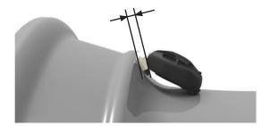
Den Sensor gegen die Felge drücken und halten, wie im vorherigen Bild gezeigt. Die T30-Schraube mit einem kalibrierten Drehmomentschraubendreher mit 6.0 Nm ±0.5 Nm festziehen.
