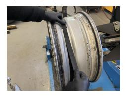
9 Die Halterung mit dem Reifenventil ausrichten, um die Demontage des Reifens zu erleichtern.
