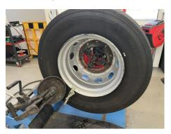
Den Reifen nach Herstellerangaben auffüllen und sicherstellen, dass die Wülste in richtiger Position sitzen.
