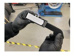
Das freie Ende des Gurtes am anderen Ende der Halterung durchführen, um eine Schlaufe zu bilden. Darauf achten, dass der Gurt nicht verdreht ist.
