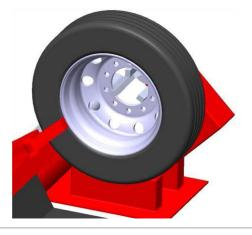
Den hinteren Reifenwulst von der Felge entfernen, während der Sensor im 180°-Winkel zum Arm stehen bleibt.
