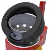
3 Den Reifenwulst über die Felge ziehen und im Bereich des Sensorbereichs auf das Felgenhorn platzieren, dass während der Montage der Sensor möglichst unberührt bleibt. Pull the tyre bead over the rim and place the tyre bead on the rim flange in the sensor area so that the sensor is touched as little as possible during installation.
