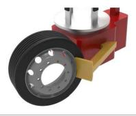
3 Die Radbaugruppe an der Reifenwechselmaschine positionieren und den Sensor im 180°-Winkel zum Arm montieren.
