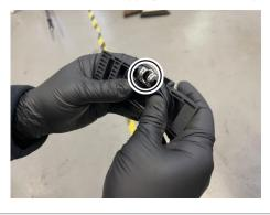
Das weiße Ende des Stoffbandes durch die Halterung führen, unter dem Sensor hindurch bis der gesamte weiße Teil auf der gegenüberliegenden Seite sichtbar wird.
