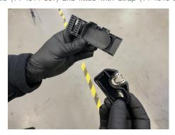
2 Den Sensor in die Halterung einsetzen, die Kunststoffführung auf den Metalleinsatz ausrichten und den Sensor einrasten lassen.
