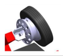
3 Den Reifen über den Sensor heben und den Wulst am Felgenhorn ablegen, sodass der Sensor beim befüllen des Reifens nicht mehr berührt werden kann.
