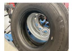
Den unteren Teil des ersten Reifenwulstes in der 6-Uhr-Position montieren (in einer Linie mit dem Sensor) und darauf achten, dass er keinen Kontakt mit der Sensoreinheit hat.\*
