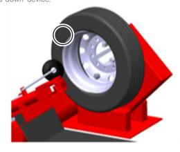
Die Felge im Uhrzeigersinn drehen und sicherstellen, dass der Sensor nicht durch den Montagevorgang eingeklemmt wurde.
