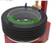
6 Den Reifen nach Herstellerangaben auffüllen und sicherstellen, dass die Wülste in richtiger Position sitzen.
