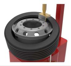
Den Sensor in einem Winkel von 180° zum Arm anbringen und den Reifen von der Felge drücken.
