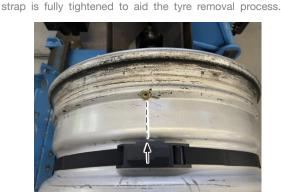
Die Felge so drehen, dass sich das Ventil in der 6-Uhr-Position befindet.\*
