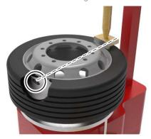
Den obersten Reifenwulst von der Felge heben. Lift the top tyre bead from the rim.
