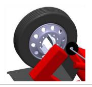
Den Sensor um 180° zum Arm ausrichten. Den Montierhaken an der Innenseite des Reifens einhaken.
