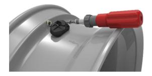
Den Sensor gegen die Felge drücken und halten, sodass dieser am Felgenbett aufliegt. Der Ventilkopf muss über eine eventuelle Senkung hinausragen, damit zwischen der Vorderseite des Sensors und der Felge ein Abstand besteht.
