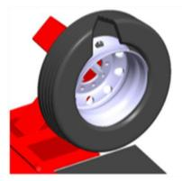
Mit der Maschine den Sensor in einem Winkel von 180° zur Maschinenwalze positionieren und mit einem Wulstniederhalter über der Walze befestigen.
