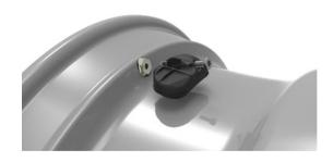
3 Den Sensor auf der Innenseite der Felge auf den Ventilkopf setzen und mit der Schraube so fixieren, dass der Sensor noch leicht bewegt werden kann.
