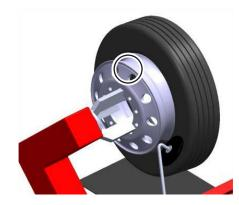
Die Schraube muss bei jedem Ausbau durch eine neue Schraube ersetzt werden, wenn der Sensor von der Felge entfernt wird. Wird das Ventil an der Felge nicht erneuert, muss das Ventilgewinde gereinigt werden, um Rückstände oder Verunreinigungen im Gewinde zu entfernen.
