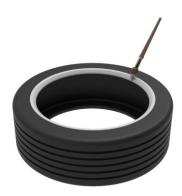
2 Den ersten Reifenwulst in das Felgenbett heben und den Reifen auf die Felge schieben, ohne den Reifendrucksensor zu berühren.
