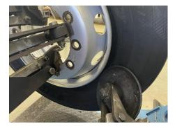
Mit dem Abdrücken des ersten Reifenwulstes mit der Abdrückscheibe beginnen und den Reifenwulst über die Halterung hinausdrücken. Mit der Demontage des Reifens gemäß den Richtlinien des Herstellers fortfahren.\*\*
