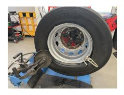
Sobald der zweite Wulst vollständig aufgezogen ist, kann der Abdrücker entfernt werden und der Reifen von der Spindel abgenommen werden.
