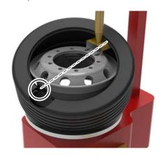
Die Schraube muss bei jedem Ausbau durch eine neue Schraube ersetzt werden, wenn der Sensor von der Felge entfernt wird. Wird das Ventil an der Felge nicht erneuert, muss das Ventilgewinde gereinigt werden, um Rückstände oder Verunreinigungen im Gewinde zu entfernen.
