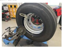
Die Felge im Uhrzeigersinn drehen und sicherstellen, dass der Sensor nicht durch den Montagevorgang eingeklemmt wurde.
