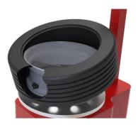
Mit der Montiermaschine die gesamte Einheit um 180° rotieren, sodass sich der Sensor an der 12-Uhr-Position am Montagekopf der Maschine befindet. Mit einem Hilfsarm der Maschine den Wulst nach unten drücken oder einen Wulstniederhalter an der 1 Uhr Position befestigen.
